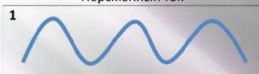
Поток электронов постоянно колеблется с определенной частотой (в 50 герц), образуя синусоиду (волнистую линию).
